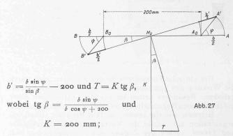
Einstellungen zur Herstellung der Ausgangslage:  $\frac{b'}{2}$  und bz =  $\Delta$  h an den Basistrommeln, h<sub>B</sub> am Z-Zählwerk und T an der Verschwenkungstrommel (Abb. 23).
