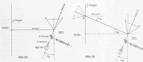
lich (Abb. 28). Um die optische Axe der Kammer in die Ziellinie zu bringen, müssen wir nachträglich das System Lenker-Kammer um ω<sub>B</sub> nach aufwärts kippen (Abb. 29). Gegenüber dem Horizont durch den Standort B nimmt dabei der Lenker die Neigung der Kammeraxe bei der Aufnahme ein (Abb. 29). Da aber die Kammer A bei der Aufnahme um den Winkel  $\omega_{\text{A}}\!
