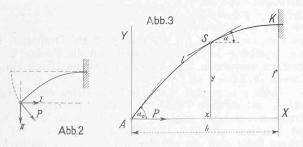
I. Am freien Ende des eingespannten schlanken Stabes greift eine Kraft senkrecht zur Einspannungsebene an.
