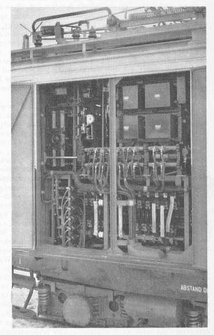
Abb, 11. Aussenansicht des geöffneten Hochspannungsraumes.
