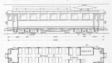
Abb. 3. Typenskizze des Motorwagens. — Masstab 1:150.
