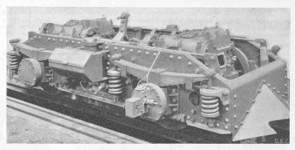
Abb. 6. Das Triebgestell der Triebwagen, Bauart S. L. M. Winterthur.
