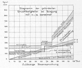
der unteren Linie, die die Anforderungen für nur ruhende Last angibt, ist deshalb noch eine höherliegende angegeben, die für den Fall gilt, dass die bewegliche Last der ruhenden gleichkommt. Mein diesbezüglicher ebenfalls eingezeichneter Vorschlag stimmt hinsichtlich der zulässigen Spannung von 40 kg/cm² mit dem Kommissionsvorschlag überein, gestattet jedoch für hochwertigen Beton 60 kg/cm² und behält die vierfache Sicherheit auch für höhere Betonqualitäten bei.
