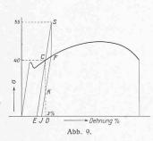
werden (Abb. 9). Wir befinden uns bei 3 % Dehnung des Stückes z. B. bei Punkt C, Spannung = 40 kg/mm². Belasten wir von aussen mit 15 kg/mm², so dehnt sich das Stück nach CF. Zur Erreichung dieses Punktes verlängert man EC über C hinaus bis 55 kg/mm² (40 + 15). Dann ziehe man eine Senk-
