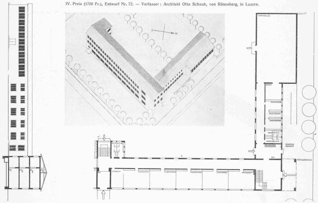
Schulhausschnitt und Hofseite Turnhalle, Erdgeschoss-Grundriss. - Masstab 1:600.
