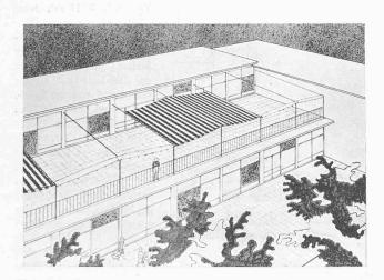
Zweigeschossige Pavillon-Schule mit zurückgesetztem Obergeschoss und Terrassendach über dem Erdgeschoss.
