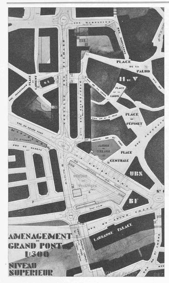
V. Preis (ex aequo), Projekt Nr. 21. Arch. E. Favre, Genf. — Ausschnitt 1:3000. Detail einer neuen N-S-Verbindung (analog dem Entwurf Nr. 20 auf S. 220), in Verbindung mit einem Strassenbahnhof, 6 m unterhalb des Niveau des Grand Pont liegend; dieser Bahnhof nimmt die als Unterpflasterlinien geführten Strassenbahnen auf.
