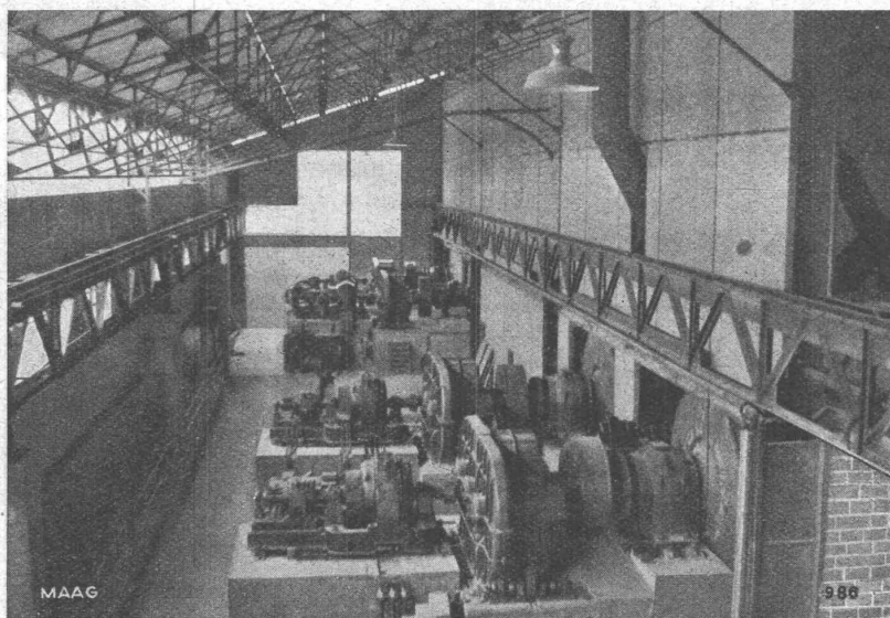
4 MAAG-GETRIEBE, Type G 95 Z II, für Zentralantrieb von Zementmühlen mit patentierter Maag-Kupplung zwischen Getriebe und Mühle. Leistung 450 PS, n = 930/21, geliefert nach Frankreich.
