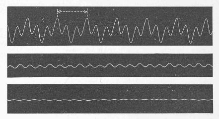
Abb. 2. Die drei Diagramme (oben: parallel; in der Mitte: quer; unten: vertikal) einer Messung beim Läuten der Glocke c (H-Boden) am 1. März 1928, 11 h. Apparatvergrösserung  $\backsim$  10-fach, Papiergeschwindigkeit v=7,52 mm/sec. Die weissgestrichelte Masslinie im obersten Diagramm bezeichnet eine Glockenschwingung. Glockenperiode  $T_{\rm C}=2,33$  sec.
