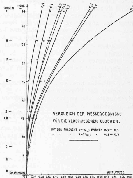
Abb. 4. Die erzwungenen Transversalschwingungen des Turmes beim Einzelläuten der vier Glocken a, b, c und e.
