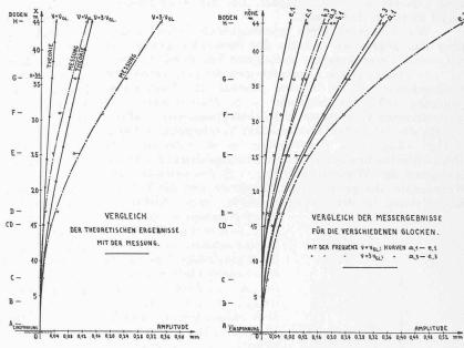
Abb. 3. Die erzwungenen Transversalschwingungen des Turmes beim Läuten der Glocke c.
