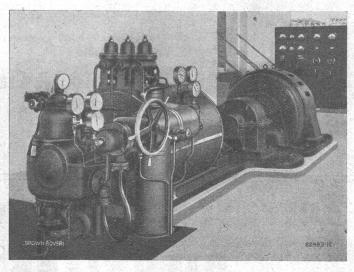
Gegendruck-Turbogruppe für eine Färberei. Leistung 380 kW, 3000/1500 Uml/min, Frischdampf 30 kg/cm² Ueberdruck, 380° C, 8,0 kg/cm² Gegendruck.
