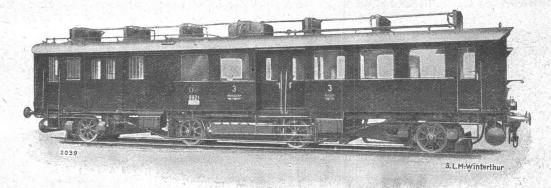
300 PS Dieseltriebwagen im Betrieb auf der Strecke Glarus-Uznach der S.B.B., ausgerüstet mit Geschwindigkeitswechselgetrieben System "S.L. M. Winterthur".
