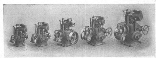
Präzisions Oeldruck Regulatoren, System "Bell", mit horizontalachsigem Patent Federgelenkpendel und Isodromvorrichtung, für jedes Turbinensystem.
