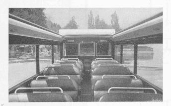
Abb. 2. Elektrisch betätigtes Rollverdeck geöffnet.
