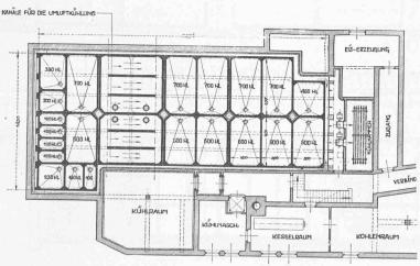
Abb. 9 und 10. Behälteranlage der Marmeladefabrik Lana für 11520 hl. — 1:380.
