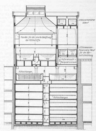
Abb. 4 und 5. Quer- und Längsschnitt des Keller-Hochhauses der Wicküler-Küpper Brauerei, Elberfeld. — Masstab 1:350. — Armaturen-Legende wie Abb. 2.
