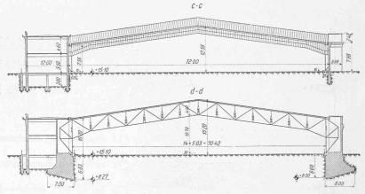
Abb. 1. Querschnitte der Autobusgarage in Budapest. - Masstab 1:850.
