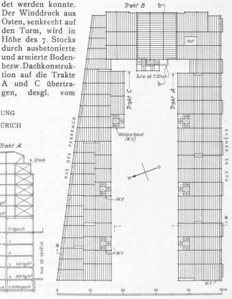
Abb. 4. Vertikalschnitte b.b durch Trakt B und Turm, a-a durch Trakt A und C. — Masstab 1:700. — Abb. 3. System der Balkenlage (Doppellinien = vertikale W.-V.).
