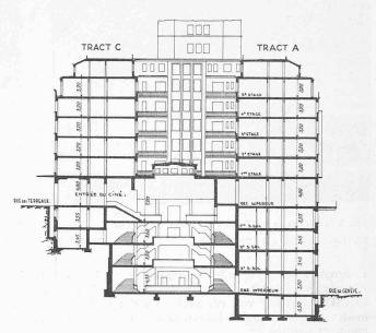
Abb. 2. Querschnitt durch Kino-Eingang und -Treppenhaus. - 1:600.
