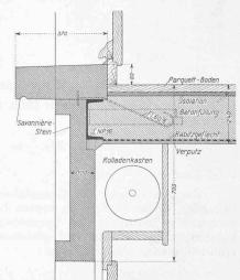
Abb. 8 bis 10. Wand- und Bodenkonstruktionen der untern (Hourdis) und der obern Geschosse, Masstab 1:15. — Stahlskelettbau der Eisenbaugesellschaft Zürich.
