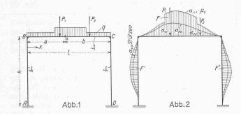
Wir bestimmen die Kurve der  $\alpha_{xx}$  (Abb. 2), indem wir in verschiedenen Schnitten des Riegels die Last  $P=\mathbf{1}$  anbringen und die zugehörigen Durchbiegungen in diesen Schnitten als Ordinaten auftragen. Die Ordinaten der  $\alpha_{xx}$ -Kurve berechnen sich nach der folgenden Formel, deren Ableitung ich hier nicht durchführen will (wenn für x=a; für (l-x)=b gesetzt wird):
