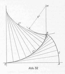
des ersten, noch nicht endgültigen Näherungsbogens, der durch das Interpolations-Verfahren ermittelte Punkt P1\* usw. Dabei ist die durch Interpolation gefundene Gerade g'\* jeweilen voll ausgezogen, während die unberichtigte Normale g' durch eine strichpunktierte Linie dargestellt ist. Die Abbildung zeigt deutlich, wie stark die Grösse von p' durch die Interpolation ab-
