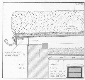
Abb. 2. Richtige Belüftung jedes Sparrenfeldes. - Masstab 1:25.
