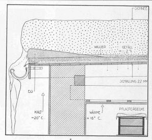
Abb. 1. Eisbildung bei nicht unterlüfteten Flachdächern. - 1:25
