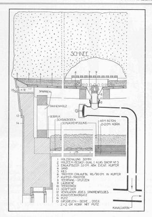
Abb. 3. Schnitt durch Gaberel-Flachdach mit innerer Entwässerung, 1:25.
