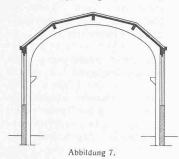
zwecklos. Dass hier die Dachhaut vermöge ihrer geknickten Form selbsttragend wirkt, lässt sich durch einen Modellversuch mit Pappe leicht veranschaulichen. Die blosse Fortlassung der Pfetten bei Dachformen nach Art der Abb. 7 ist allerdings zunächst nur ein negativer Schritt. Bei richtiger Erkenntnis des Kräfte-
