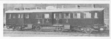
Abb. 1. 300 PS Dieseltriebwagen der Schweizerischen Lokomotiv- und Maschinenfabrik Winterthur.
