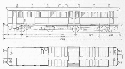
Abb. 2. Grundriss und Ansicht des normalspurigen Dieseltriebwagens. - Masstab 1:150.
