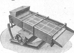
Ausführungen für Stundenleistungen bis 30 m³, mit 2 bis 5 Aussortierungen.
