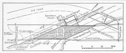
Abb. 1. Grundriss der schiefen Klappbrücke über den Delaware and Raritan Canal zwischen Trenton und Princeton, New Jersey, U. S. A. — Masstab 1:1000. — C. L. = Axe, trunnion = Drehzapfen.
