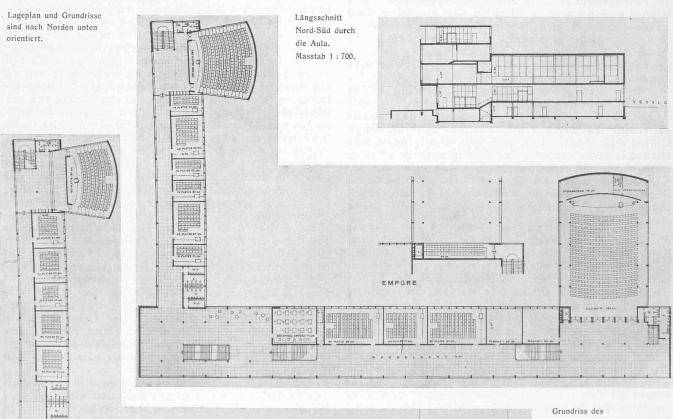
Grundriss des ersten Hörsaalgeschosses, links darunter des zweiten Hörsaalgeschosses. Masstab 1:700.
