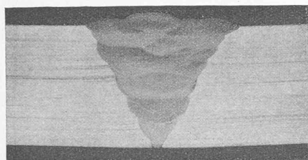
Ober Mikrogefüge in 200facher Vergrößerung. Unten Makrogefüge in natürlicher Grösse.
