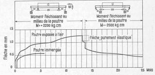
Fig. 9. Variation de la flèche d'une poutre sollicitée à la flexion en fonction du temps. Le moment de flexion indiqué comprend l'influence du poids propre; la flexion moyenne déterminant la flèche sur la longueur observée de 120 cm eté d'environ 2300 kg·cm pendant la première période de charge et 1900 kg·cm pendant la seconde.
