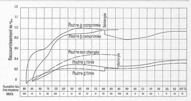
Fig. 7. Déformation de poutres de béton à 200 kg de ciment par  $m^3$ , sollicitées axialement par une charge permanente. Avant leur mise sous charge les poutres ont été conservées dans l'eau. La poutre a a été sollicitée à la compression dès le début à 30 kg/cm² et la poutre d à la traction à 8 kg/cm². Les poutres b et c ont été soumises progressivement aux mêmes charges. Après 10 respectivement 11 mois les poutres ont été déchargées et une partie soumise à la flexion.
