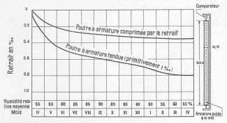
Fig. 8. Retrait de poutres de béton à 200 kg de ciment par  $\rm m^3$  avec armature axiale. Dans l'une des poutres l'armature était libre lors du bétonnage, dans l'autre au contraire l'armature avait subi une extension de  $\rm 1^0 l_{00}$ .
