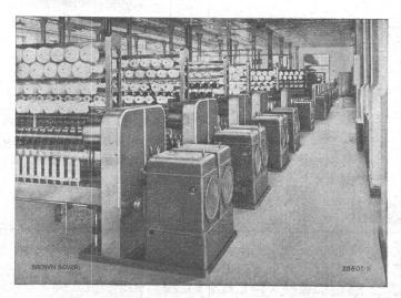
Antrieb von doppelten Baumwoll-Ringspinnmaschinen mit Dreiphasen-Kommutatormotoren.
