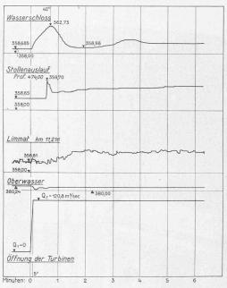
Abb. 19. Diagramm eines Schwallversuches. Oeffnen der Turbinen von 0 auf 120 m $^3$ /sec in 5 sec bei  $Q_{\rm Limmat} = 500$  m $^3$ /sec. (Versuch 3a.)
