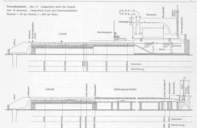
dies in Wirklichkeit der Fall ist. An Stelle der Leitschaufeln der Turbinen wurden drei vertikale Zylinderventile (Abb. 18) eingebaut, die durch einen Servomotor, der in Abb. 15 sichtbar ist, nach beliebigen Vorschriften linear mit der Zeit bewegt werden konnten. Insbesondere erlaubte der Servomotor die Einhaltung beliebiger Oeffnungsgrade und beliebiger Schliess- und Oeffnungszeiten. Da auf
