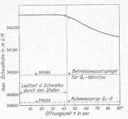
Abb. 21. Schwall im Wasserschloss, Maximaler Schwall in Funktion der Oeffnungszeit der Turbinen bei QT = 0 bis 120 und QL = 500 m³/sec.
