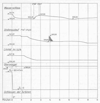
Abb. 22. Diagramm eines Sunkversuches (Versuch 4). Schliessen der Turbinen von 120 auf 0 m $^3$ /sec in 5 Sekunden bei  $Q_{\rm Limmat} = 0$  m $^3$ /sec.
