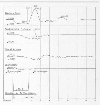
Abb. 23. Resonanzerscheinung (Versuch 3c). Schliessen der Turbinen von 120 auf 0 m<sup>8</sup>/sec in 5 Sekunden, nach 100 Sekunden Oeffnen der Turbinen von 0 auf 120 m<sup>8</sup>/sec in 5 Sekunden. QLimmat = 500 m<sup>8</sup>/sec.
