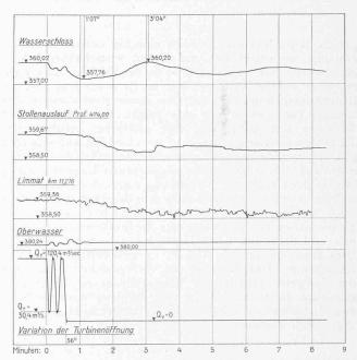
Abb. 24. Interferenzerscheinungen (Versuch 37). Abwechselndes Schliessen und Oeffnen der Turbinen von 120 auf 30 m³/sec.  $Q_{\rm Limmat}=580$  m³/sec.
