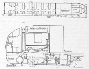
Abb. 6. Schnelltriebwagen für 150 km/h, zwei Motoren zu je 410 PS. Grundrissdisposition 1:250, Längsschnitt durch Maschinenraum 1:88.
