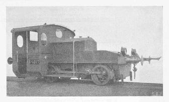
Abb. 3. Kleinlokomotive mit Verbrennungsmotor von 50 PS für leichten Rangierdienst, Bauart Orenstein und Koppel — Vergl. Text Seite 69.
