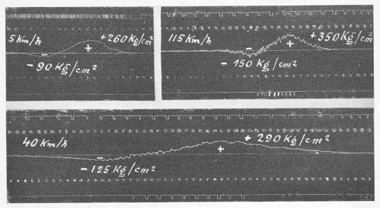
Abb. 12. Spannungsdiagramme der Strebe einer Fachwerkbrücke bei Geschwindigkeiten der Lokomotive von 5, 40 und 115 km/h. Diagrammordinate: 1 mm = 50 kg/cm² Spannung.
