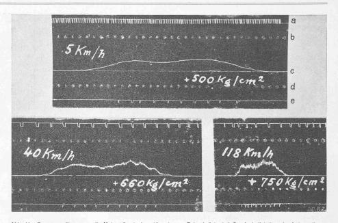
Abb. 11. Spannungsdiagramme (in Naturgrösse) einer 10 m langen Trägerbrücke bei Geschwindigkeiten der Lokomotive von 5, 40 und 118 km/h; Diagramm-Ordinate: 1 mm = 100 kg/cm² Spannung. a Zeitzeichen = 1/5 Sekunde, b und d Erhöhungen im Papier, c Diagramm, e Zeichen herrührend von den Lok.-Achsen.
