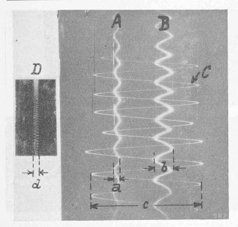
Abb. 6. Oszillogramm von 100 Schwingungen in der Sekunde zur Erprobung des Spannungsmessers.
