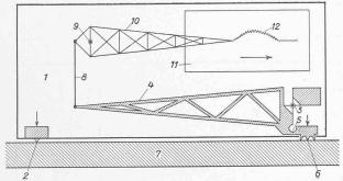
Abb. 1. Schematische Darstellung des Spannungsmessers Bauart Meyer.
