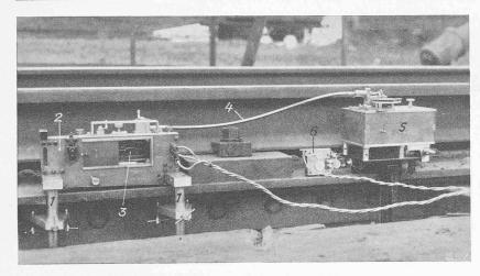
Abb. 9. Spannungsmesser Bauart Meyer am Obergurt einer Blechträgerbrücke angespannt. Messlänge 20 cm. — 1 Anspannklammern, 2 Spannungsmesser, 3 Diagramm, 4 Biegsame Welle, 5 Motor, 6 Zeitzeichengeber.
