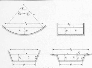
Abb. 5 bis 8. Verschiedene untersuchte Profilformen.
