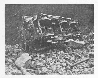
Abb. 1. Das obere Triebgestell der am 3. August 1931 abgestürzten elektrischen Lokomotive Nr. 411 der Rhätischen Bahn.
