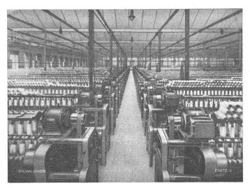
Einzelantrieb v. Ringspinnmaschinen durch aufgebaute Kurzschlussankermotoren.
