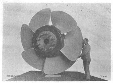
Laufrad einer der 10000 PS Kaplan-Turbinen des Kraftwerkes Weitingen für 23 m Gefälle, bisheriges Höchstgefälle der Kaplan-Turbinen.
