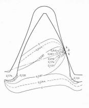
Abb. 20 und 21. Hauptschubspannungslinien im Zahn eines Zahnrades in der Mittellage des Eingriffs.
