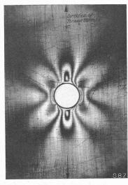
Abb. 15. Hauptschubspannungslinien eines gelochten Zugstabes.
