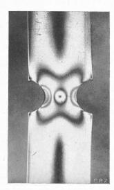
Abb. 17. Stab mit Rundkerbe, links Zug-, rechts Biegungsbeanspruchung.
