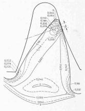
Abb. 22. Hauptschubspannungslinien im Zahn eines Zahnrades kurz vor Vollendung des Eingriffs.
