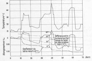
Fig. 1. Déformation linéaire d'une poutre de 2 m de longueur en béton à 400 kg de ciment par m³ immergée dans l'eau, en fonction de la température et du temps. Les appareils de mesure (comparateurs Stoppani) étant fixés à des tiges d'acier de même longueur que la poutre, on observe la différence entre la dilatation thermique de l'acier et celle du béton. On a déterminé  $\alpha \, \mathrm{Béton} = 0,0000119 - 0,0000037 = 0,0000082 = \sim 2/3 \, \alpha \, \mathrm{Fer}$ .
