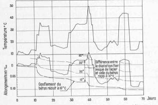
Fig. 1. Déformation linéaire d'une poutre de 2 m de longueur en béton à 400 kg de ciment par m³ immergée dans l'eau, en fonction de la température et du temps. Les appareils de mesure (comparateurs Stoppani) étant fixés à des tiges d'acier de même longueur que la poutre, on observe la différence entre la dilatation thermique de l'acier et celle du béton. On a déterminé  $\alpha \, {\rm Béton} = 0,0000119 - 0,0000037 = 0,0000082 = \sim 2/3 \, \alpha \, {\rm Fer}.$
