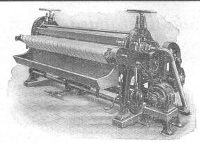
Neue Muldenmangel CD mit direktem Motorantrieb, doppelseitiger Wrasenabsaugung, automatischer Wäscheeinführung, Walzenhebung und Abstreifvorrichtung.
