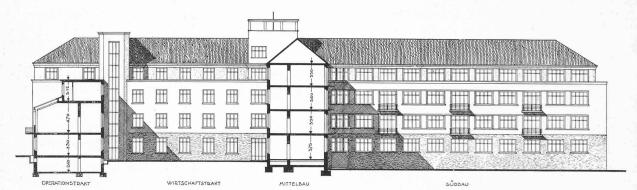
Abb. 7. Schnitt durch Operationsflügel, Hof und Mittelbau, Ansicht der Westfront des Südbaues mit Krankenzimmern. — Masstab 1:500.
