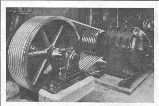
Antrieb eines Kompressors, 130/150 PS
