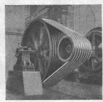
Antrieb eines Kompressors, 125 PS.
