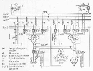
Abb. 50. Schema der Synchronisierungs-Einrichtungen.
