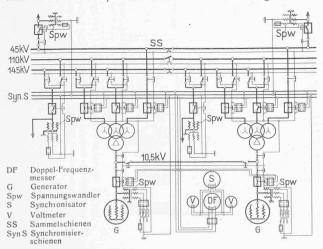
Abb. 50. Schema der Synchronisierungs-Einrichtungen.
