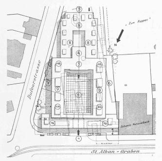
Abb. 3. Umgearbeiteter Entwurf Christ-Büchi, Januar 1931. — 1:1500. Legende: 1 Haupteingang, 2 Hof, 3 Eingangshalle, 4 Hauptereppe, 5 Vortragsaal, 6 Kupferstichkabinett, 7 Depotgalerie (Erdgeschoss), 8 Alte Galerie mit Oberlicht, 9 Galerie mit Seitenlicht, 10 Galerie mit Oberlicht (8, 9 und 10 im I. Stock), 11 Moderne Galerie im II. Stock mit Oberlicht.
