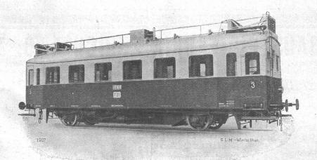
Dieseltriebwagen von 130 PS Leistung der Süddeutschen Eisenbahn-Gesellschaft Darmstadt, ausgerüstet mit einem kompletten vierstufigen Antrieb System "S. L. M.-Winterthur".
