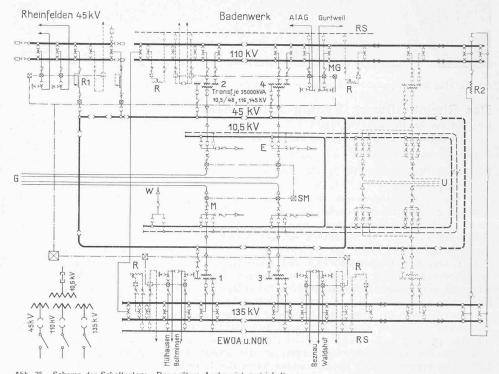
Abb. 35. Schema der Schaltanlage. Der spätere Ausbau ist gestrichelt. Legende: E Eigenbedarf, G von den Generatoren, M Messeinrichtung (die bestehenden Punkte werden später gleich ausgebildet wie die rechts gestrichelten), R Regulierung,  $R_1$  Regulierung 45 kV  $\pm$  15  $\eta_0$ ,  $R_2$  Regulierung 110 oder 135 kV  $\pm$  15  $\bar{\eta}_0$ , 35000 kVA Durchgangsleistung, RS Regulierschiene, SM Summenmessung,  $\bar{U}$  zu den Umformern 12000 kW, W Belastungswiderstand.
