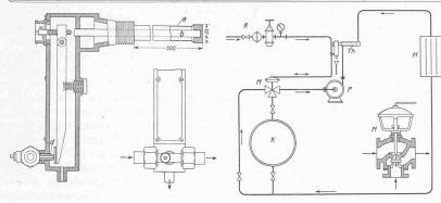
Abb. 2. G-S-T-Thermostat. - Masstab 1:5.
