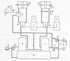
Abb. 27. Vereinfachtes Schema der Regulierung einer Turbine. (Rücklaufleitungen, Rückführungsgestänge usw. sind nicht dargestellt.)
