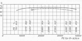
Abb. 29. Wirkungsgrad der Turbine 1, in Funktion der Leistung.
