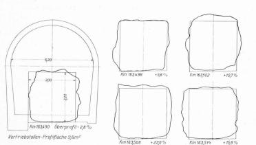
Abb. 43. Normal- und Ueberprofile, mit dem Pantographen (1:20) aufgenommen. - 1:150.
